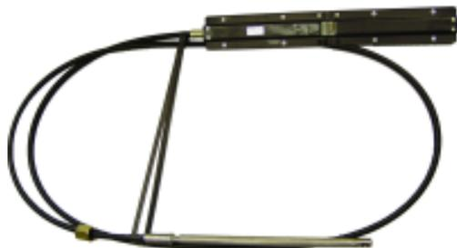
Scatola di guida completa di monocavo. Costruita con materiali resistenti alla corrosione marina, estremità del monocavo in acciaio inox, 3,5 giri del volante, 210 mm. corsa di azionamento. Conforme alla normativa EN 28848 - ABYC P17. Coprimozzo non incluso
