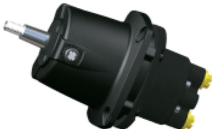
Montaggio frontale, dotata di valvola di non-ritorno che impedisce la reversibilità. Valvola di protezione alle sovrappressioni integrata. Alberino conico in acciaio inox da 3/4". Serbatoio in materiale composito resistente alla corrosione. Valvola di non-ritorno e guarnizione alberino facilmente accessibili in caso di sostituzione. Adatta solamente al cilindro UC81-OBF. Installazione a semi-incasso. Peso kg 3,6
