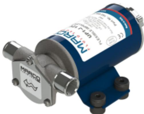
Pompa UP1-J autoadescante dotata di portaspazzole interno con filtro antisturbo EMI, girante in gomma, corpo in ottone nichelato con albero in acciaio inossidabile, calotta impermeabile e passacavo stagno. Ideale per svuotamento sentine e acque grigie su ogni tipo di imbarcazione. ISO 8849 e ISO 8846.
