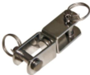
Girella stampata in acciaio inox con perni sfilabili. Dimensioni larghezza mm. 11, interasse mm. 34, perno Ø mm. 5, carico rottura Kg. 480.
