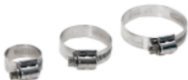
Fascetta stringitubo originale ABA in acciaio inox AISI 316. Con vite a testa esagonale ataglio per cacciavite. Banda sagomata non perforata. E' una fascetta da utilizzare in ambienti altamente corrosivi, quali l'industria chimica, l'industria alimentare, le birrerie, gli ambienti marini, ecc.
