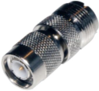
Adattatore da PL259 femmina a connettore TNC maschio serve a collegare i CB, i VHF, AIS, GPS e tutti gli strumenti con connettore TNC a cui ci deve essere collegato un antenna esterna compatibile dotata di connettore PL259 maschio.
